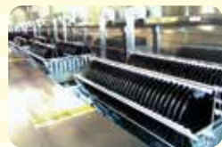
洗浄工程 レンズ表面に付着している埃や汚れ等を超音波洗浄を行い綺麗な状態に仕上げます。
