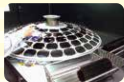
蒸着工程① 専用治具にレンズをセットして蒸着機へ。真空蒸着を行います。
