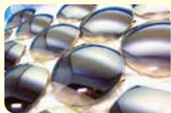
蒸着工程② 真空蒸着後のレンズ。光学特性の確認を行います。
