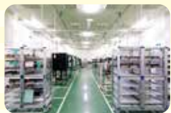
蒸着工程クリーンルーム クリーン化された環境で生産することで品質を安定させています。
