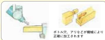
ボトル穴、アリなどが機械により正確に加工されます
