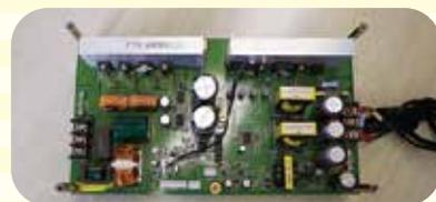
※完成した電子回路は電動アシスト付自転車の充電器、リモコンエンジンスターターのリチウム電池や新幹線の蓄電池などに使われます。
