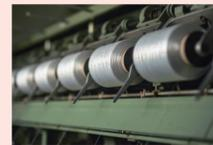
原糸を必要に応じて分割し、燃糸機にて燃り(ねじり)をかけます。
