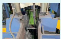
鋼材を専用マシンでボルト穴を開け、
